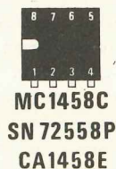
Fig. 5 Zoccolature del doppio amplificatore differenziale. Questo integrato può essere reperibile nelle seguenti sigle - MC.1458/C - SN72558/P - CA.1458/E - SFC.2458/DC.
