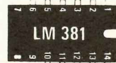
Fig. 5 Numerazione dei terminali dell'integrato LM381 visto da sopra. (Si noti la tacca di riferimento).
